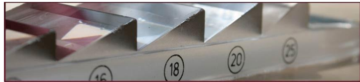
Querschnitt durch ein Glas mit aufgesetzten Prismen zunehmender Stärke
